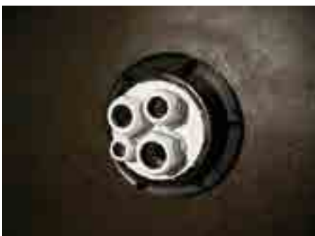
4. HL801 Rohrdurchführung mit fixierten Durchgangsschraubungen in die vorbereitete Rohrabdichtung (HL800) einsetzen, Sicherheitsmutter der Rohrabdichtung HL800 festziehen
